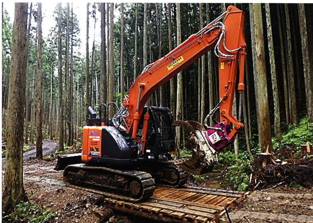
新設した木橋を走行するフェラーバンチャザウルスの様子
