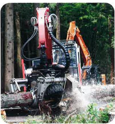
プロセッサによる造材作業
